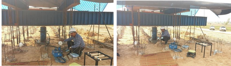
รูปที่ 3.9-7 การทดสอบ Static Pile Load Test บริเวณโครงการ
