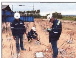
รูปที่ 3.9-3 ภาพแสดงการทดสอบความสมบูรณ์ของเสาเข็ม วิธี Seismic Test
