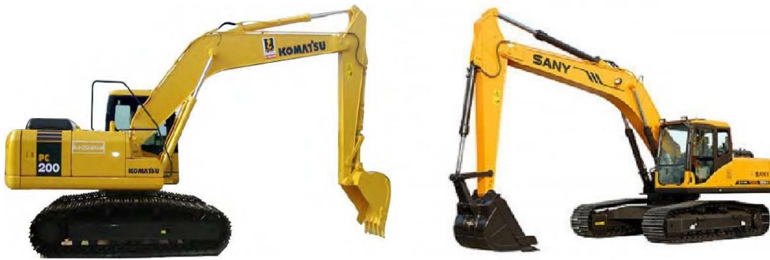
รถขุดไฮดรอลิก(Excavator Back-Hoe)
