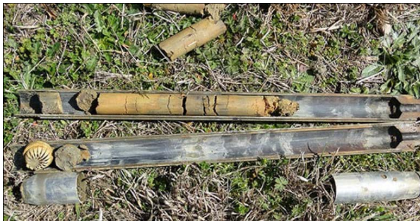
รูปที่ 29 การเก็บตัวอย่างดินแบบเปลี่ยนสภาพโดยใช้กระบอบอกผ่า (EXE., 2019)
