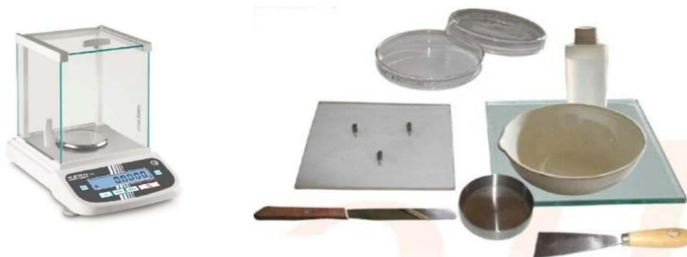
รูปที่ 48 อุปกรณ์ที่ใช้ในการทดสอบหาขีดจำกัดหดตัว (Singh, S., 2021)
