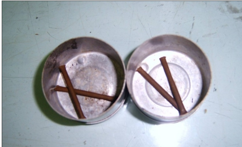
รูปที่ 50 ตัวอย่างดินที่คลึงจากการทดสอบหาขีดจำกัดพลาสติก (สุชาติ ทองเงิน, 2557)
