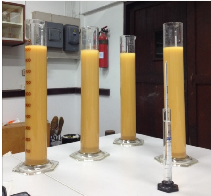
รูปที่ 45 การวิเคราะห์ขนาดเม็ดดินด้วยวิธีไฮโดรมิเตอร์ (สุชาติ ทองเงิน, 2557)
