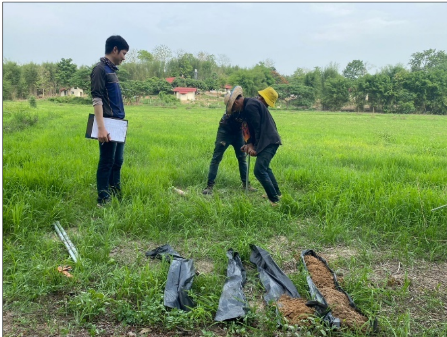
รูปที่ 26 การเจาะเก็บตัวอย่างด้วยสว่านมือหมุน
