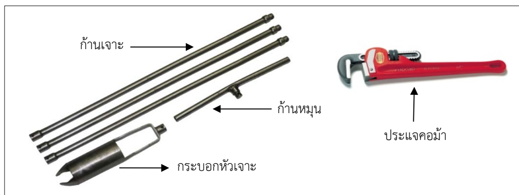
รูปที่ 25 อุปกรณ์สำหรับเจาะเก็บตัวอย่างด้วยสว่านมือหมุน
