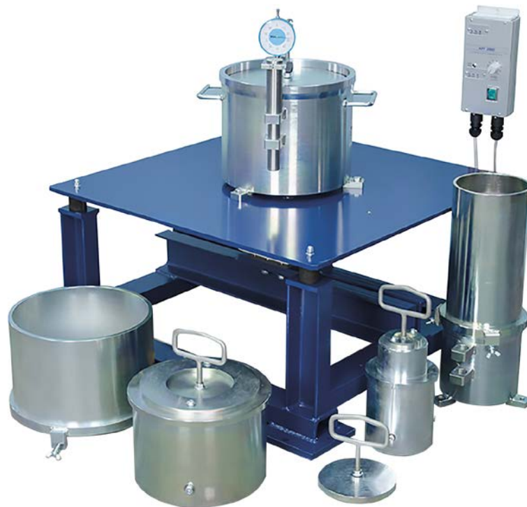
รูปที่ 52 โต๊ะสั่น พร้อมอุปกรณ์สำหรับทดสอบความหนาแน่นสัมพัทธ์
