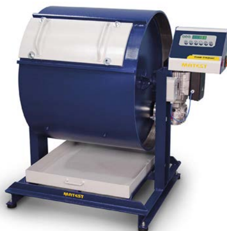
รูปที่ 53 เครื่อง Los Angeles Abrasion สำหรับทดสอบความสึกกร่อนของวัสดุ
