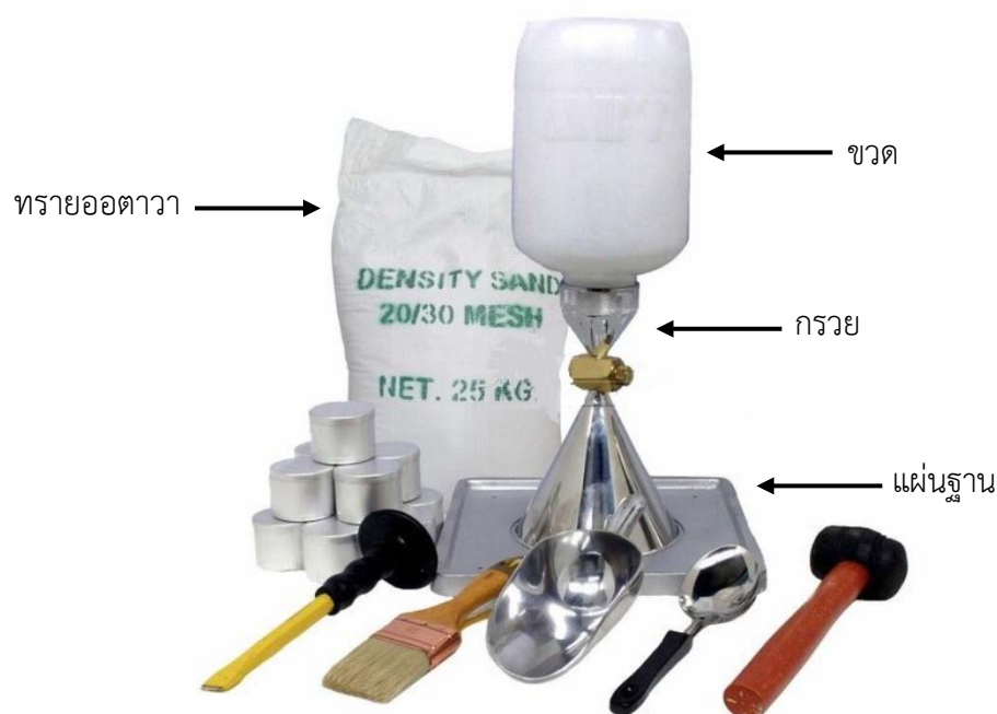
รูปที่ 42 ชุดเครื่องมือทดสอบความหนาแน่นในสนามโดยใช้ทราย
