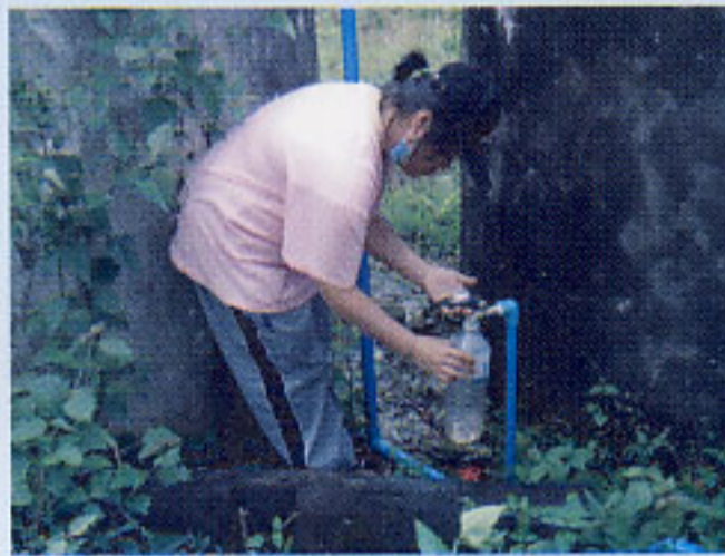
๓) เปิดก๊อกน้ำหมายเลข ๑ ใช้ขวดน้ำดื่มขนาด ๑.๕ ลิตร ตวงปริมาตรน้ำให้เต็มขวดภายในเวลา ๕๕ วินาที
