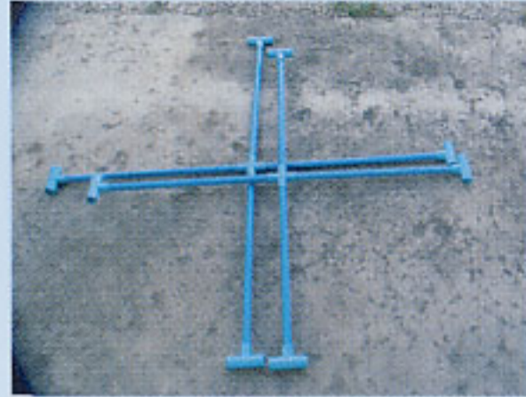
๒) ประกอบท่อพีวีซี Ø ๓/๒" และอุปกรณ์ เป็นรูปกากบาทตอกให้แน่น จำนวน ๒ ชุด
