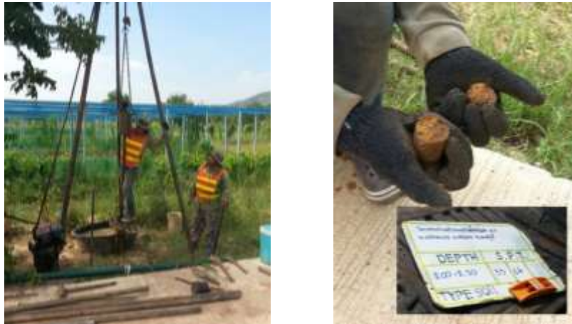
รูปที่ 4 การทดสอบการรับน้ำหนักบรรทุกของดิน โดยวิธี Standard Penetration Test
