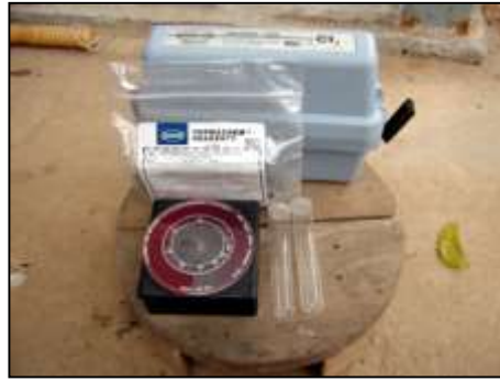
รูปที่ 56 ชุดวิเคราะห์ปริมาณคลอรีนหลงเหลือในน้ำ
