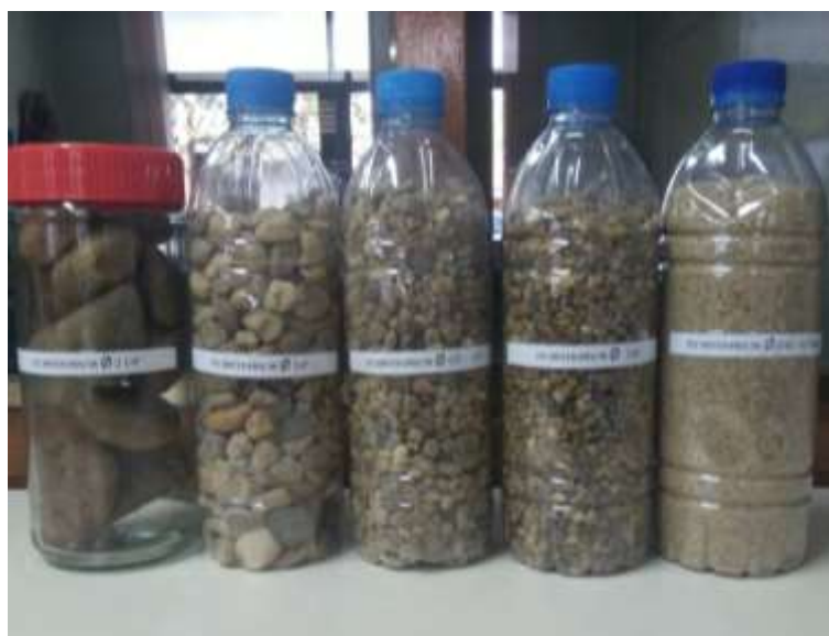
รูปที่ 60 ตัวอย่างกรวดกรอง และทรายกรอง ที่ใช้ในงานระบบประปาหมู่บ้าน
