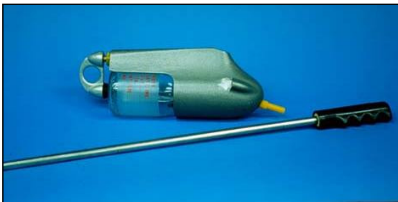
รูปที่ 2 Depth-Integrating Sampler (US DH-48) (ที่มา: U.S. Geological Survey (2005))
