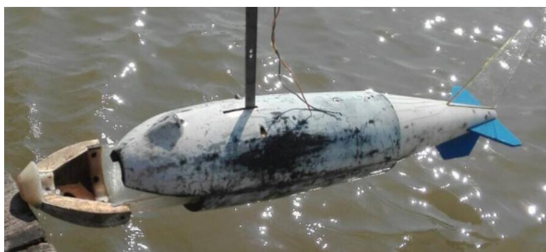
รูปที่ 4 Depth-Integrating Sampler (US D-96)
