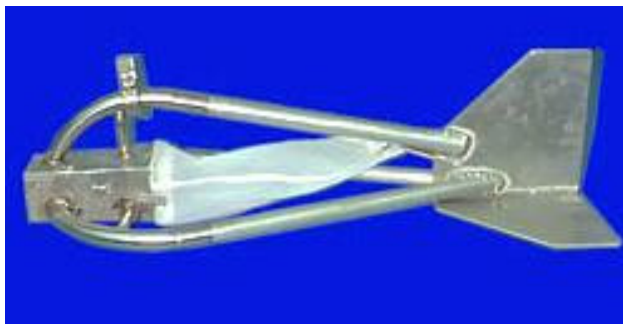
รูปที่ 5 Bedload Sampler (US BL-84) (ที่มา: U.S. Geological Survey (2005))
