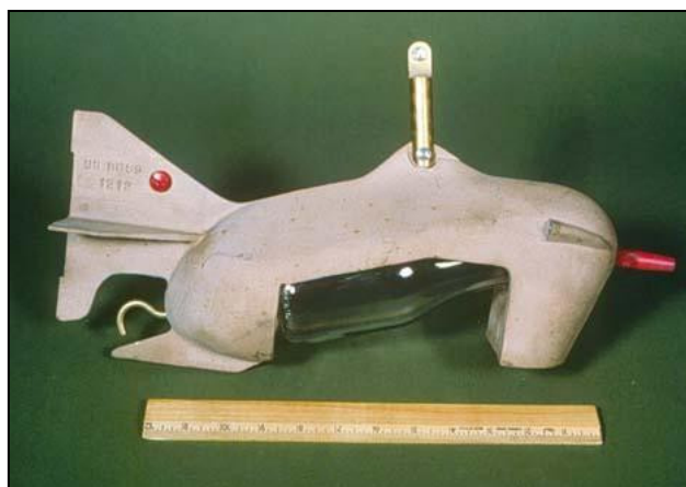
รูปที่ 3 Depth-Integrating Sampler (US DH-49) (ที่มา: U.S. Geological Survey (2005))
