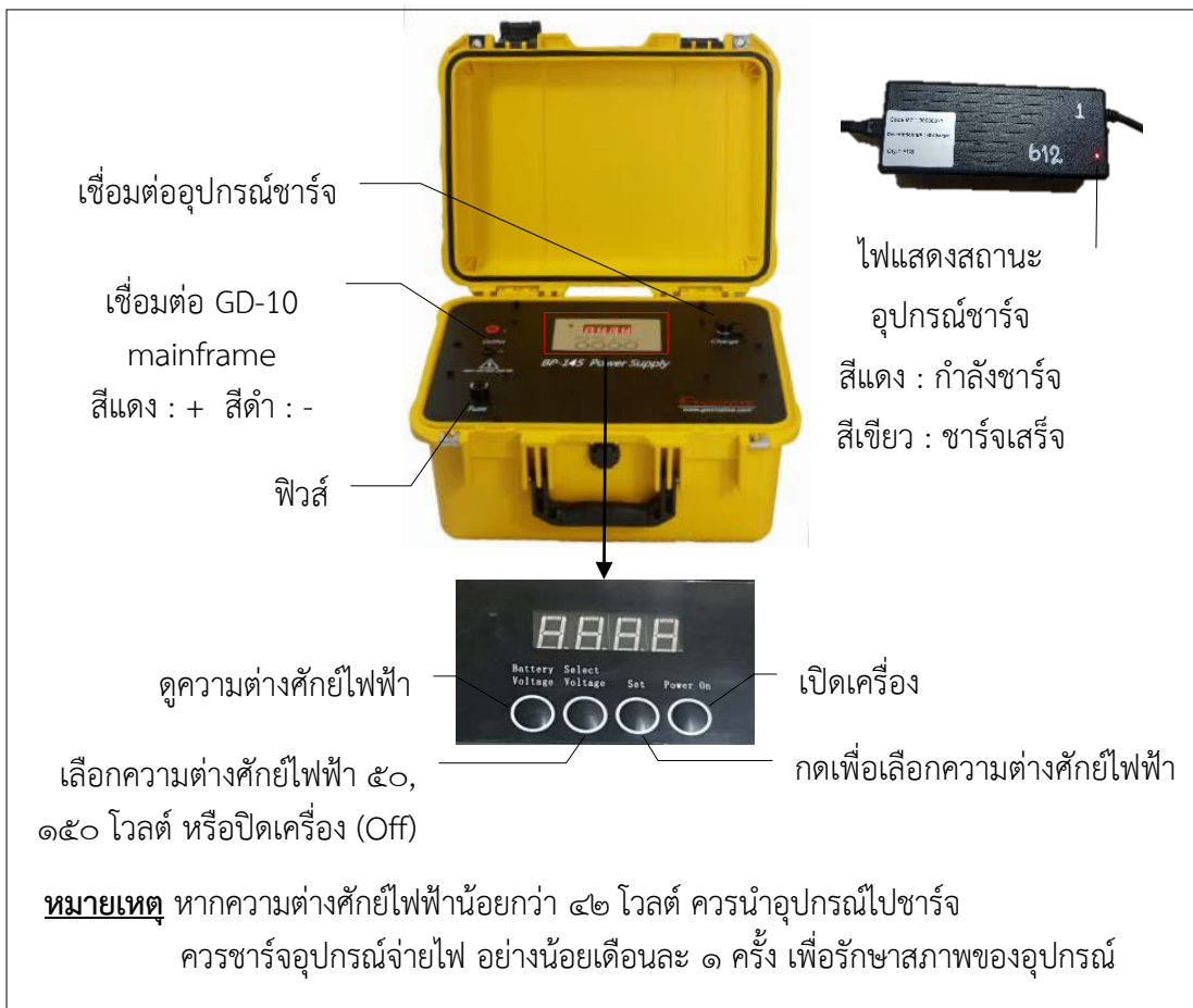
รูปที่ ๒-๒๓ อุปกรณ์จ่ายไฟ BP-145
