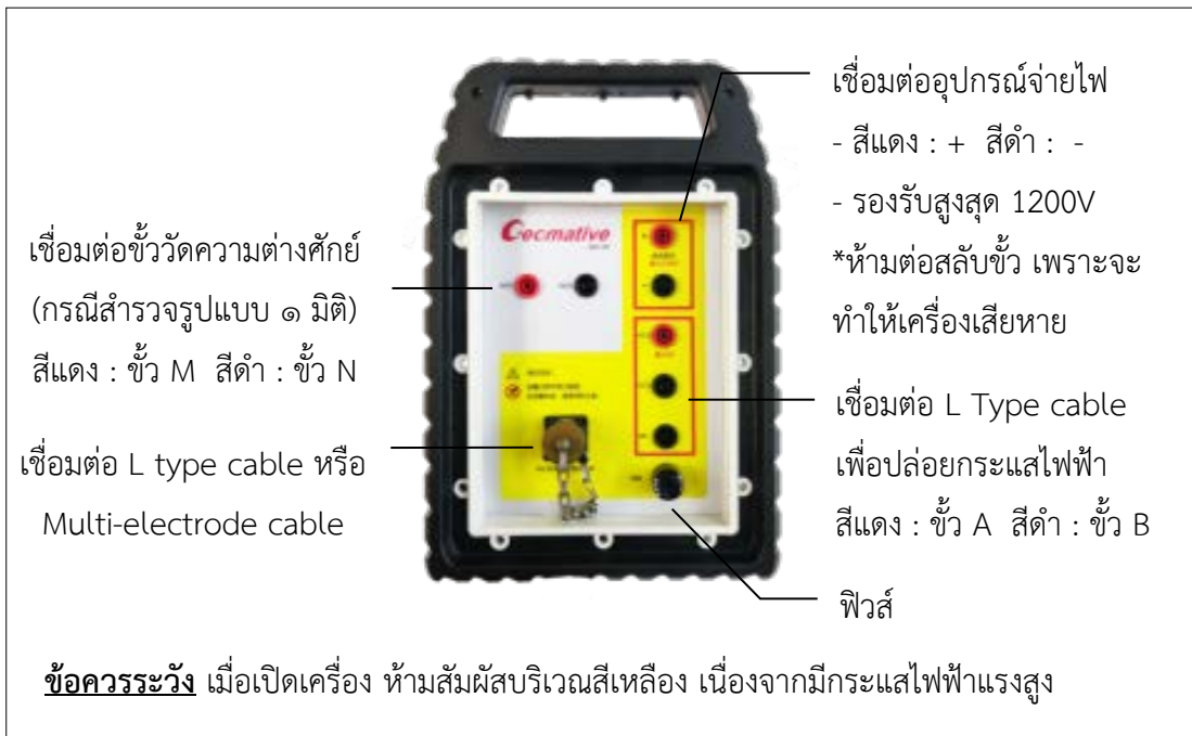
รูปที่ ๒-๑๖ เครื่อง GD-10 mainframe ด้านขวา
