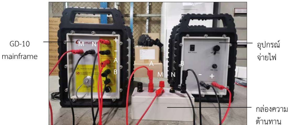
รูปที่ ๒-๒๔ วิธีการเชื่อมต่อการปรับเทียบเครื่อง GD-10 mainframe กับกล่องความต้านทาน
