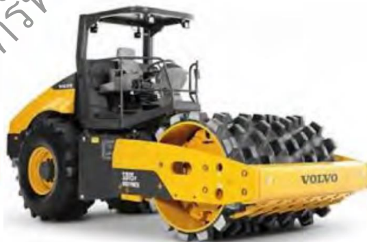
รูปที่ ๕.๒.๒-๗ รถบดล้อเหล็กหนามแบบสันสะเทือน (Vibrate Sheep Foot Wheel Rollers)
