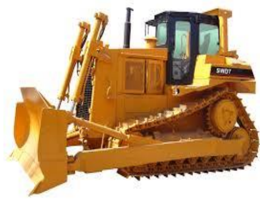
รูปที่ ๕.๒.๒-๓ รถแทรกเตอร์ตีนตะขาบกว้าง (Low Ground Tractor)
