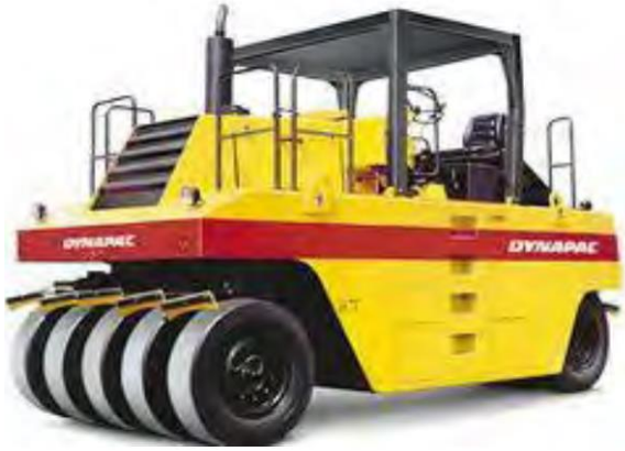
รูปที่ ๕.๒.๒-๖ รถบดล้อยาง (Rubber Tire Roller compactor)
