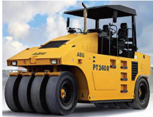
รูปที่ ๕.๒.๒-๖ รถบดล้อยาง (Rubber Tire Roller compactor)
