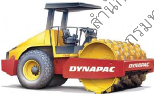
รูปที่ ๕.๒.๒-๗ รถบดล้อเหล็กหนามแบบสันสะเทือน (Vibrate Sheep Foot Wheel Rollers)
