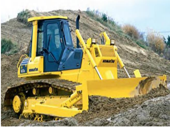
รูปที่ ๕.๒.๒-๓ รถแทรกเตอร์ตีนตะขาบกว้าง (Low Ground Tractor)
