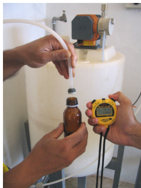
รูปที่ 30 การหาอัตราการจ่ายสารละลายคลอรีนโดยวิธีการตวงจับเวลา
