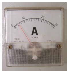
รูปที่ 50 แอมป์มิเตอร์
