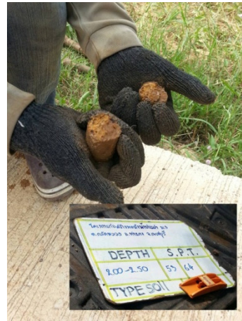
รูปที่ 4 การทดสอบการรับน้ำหนักบรรทุกของดิน โดยวิธี Standard Penetration Test
