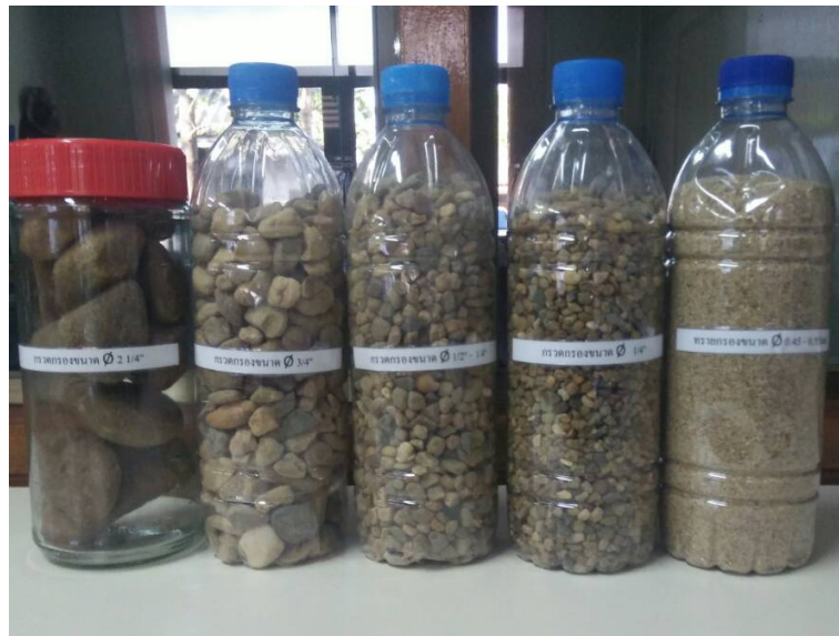
รูปที่ 60 ตัวอย่างกรวดกรอง และทรายกรอง ที่ใช้ในงานระบบประปาหมู่บ้าน
