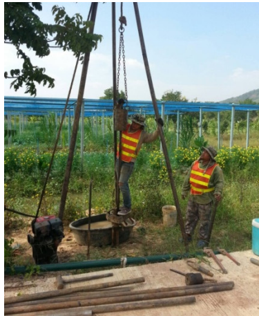
รูปที่ 4 การทดสอบการรับน้ำหนักบรรทุกของดิน โดยวิธี Standard Penetration Test
