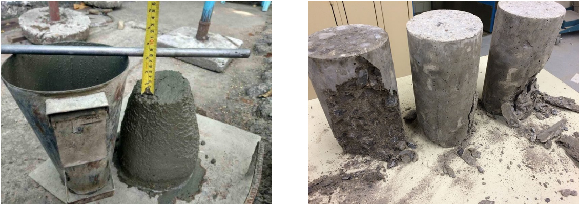
รูปที่ 15 การทดลองยุบตัวของคอนกรีต (SLUMP TEST) และการทดสอบคอนกรีตรูปทรงมาตรฐาน (รูปทรงกระบอก)
