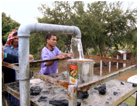
รูปที่ 51 การตรวจสอบปริมาณการสูบน้ำของเครื่องสูบน้ำบาดาล
