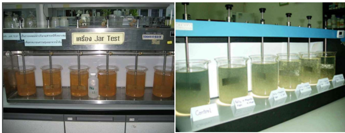
รูปที่ 2-2 เครื่องจาร์เทสต์ ชนิด 6 ไบพัต
