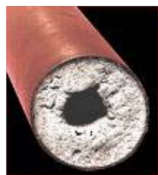
รูปที่ 2-11 หินปูนในกาท้มน้ำและหินปูนอุดตันในท่อ
