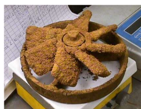
ใบพัดเครื่องสูบน้ำ เสียหาย
