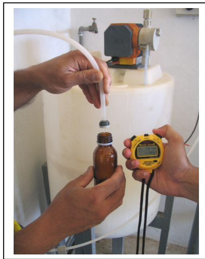
รูปที่ 32 การหาอัตราการจ่ายสารละลายคลอรีนโดยวิธีการตวงจับเวลา
