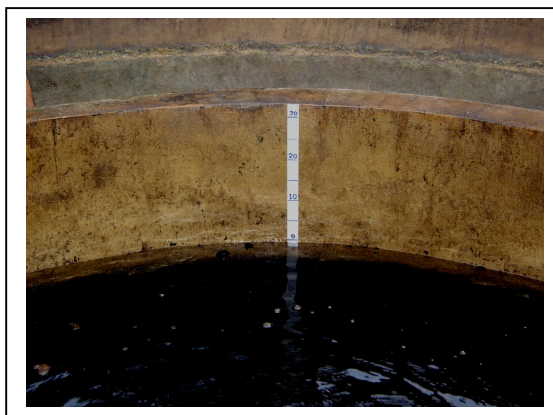
รูปที่ 20 การขีดระดับเพื่อวัดปริมาณน้ำดิบ
