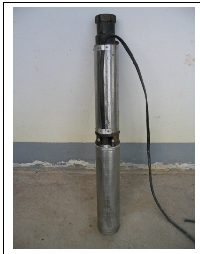
รูปที่ 3 เครื่องสูบน้ำแบบจมใต้น้ำ (ซบเมสซิเบิ้ล)
