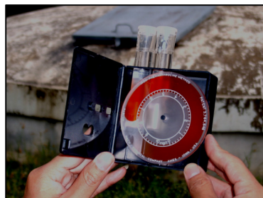
รูปที่ 72 การหาปริมาณเหล็กในน้ำดิบโดยวิธีการเทียบสี
