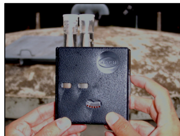
รูปที่ 72 การหาปริมาณเหล็กในน้ำดิบโดยวิธีการเทียบสี
