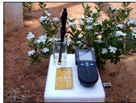
จุ่มพี เอช มิเตอร์ลงในสารละลายมาตรฐานเพื่อปรับความถูกต้องของเครื่องมือ
