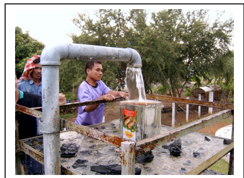
รูปที่ 18 การวัดปริมาณน้ำดิบเข้าสู่ระบบผลิตน้ำ โดยวิธีดวงจับเวลา
