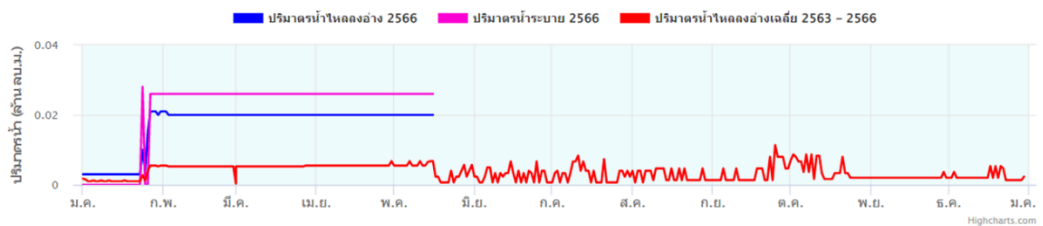
ภาพประกอบ 4-25 โค้งบริหารจัดการน้ำอ่างเก็บน้ำห้วยน้ำคลองพรุเคย จังหวัดตรัง
