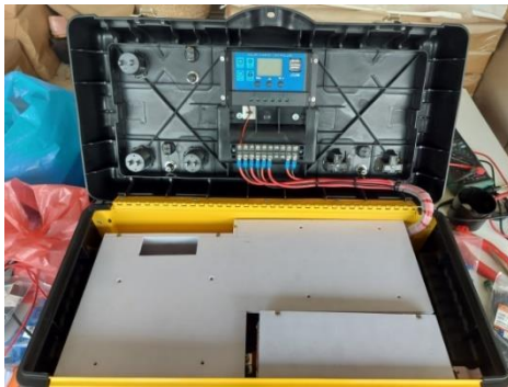
ภาพที่๑๕ การเดินสายไฟจากชุดจ่ายแบตเตอรี่ด้านล่าง มาตัวเทอร์มินอลต่อสายไฟชุดด้านบน
