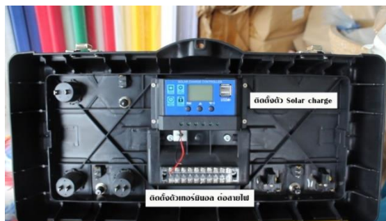
ภาพที่๑๓ การติดตั้งตัว Solar charge และ เทอร์มินอลต่อสายไฟ
